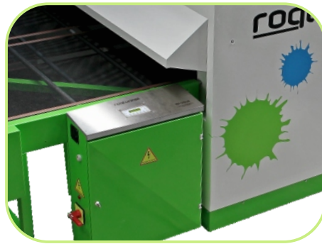
painel de comando
